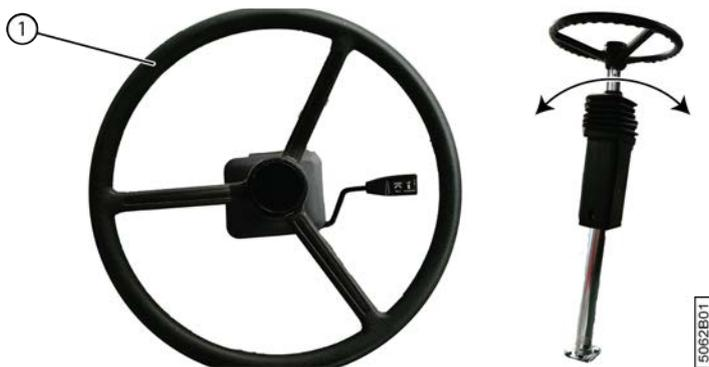
Fig. 82: Poignée de la colonne de direction
