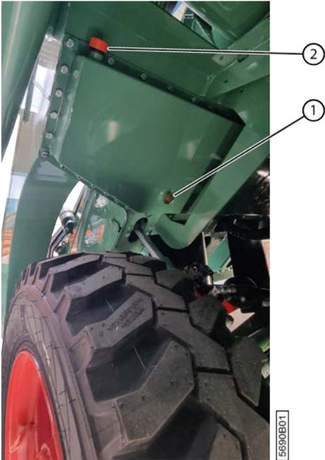
Fig. 108: Faire l'appoint d'huile de l'engrenage de l'arracheur
