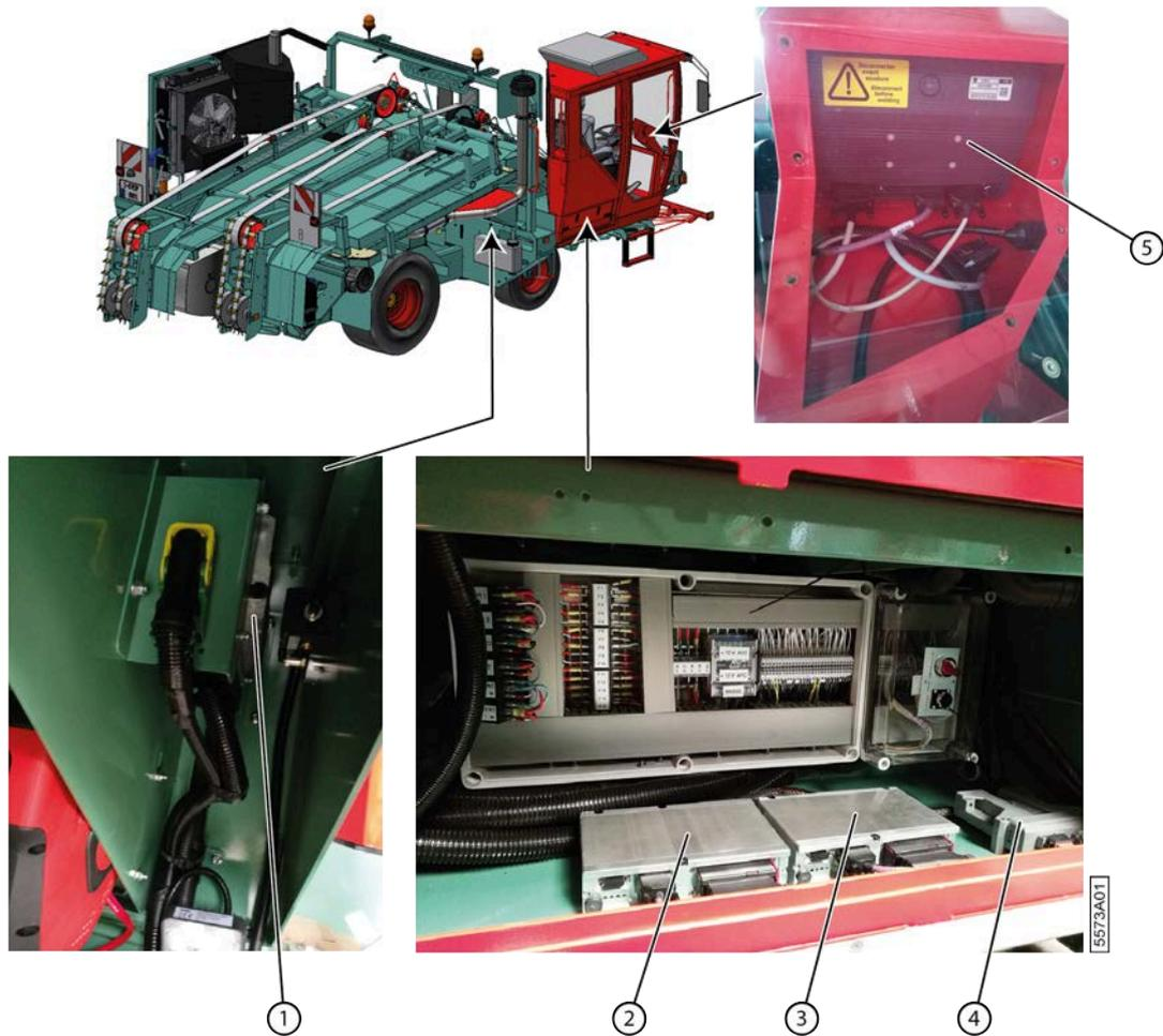
Fig. 165: Emplacement des contrôleurs
