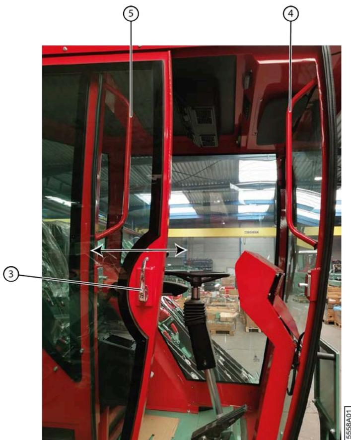
Fig. 10: Porte à l'extérieur de la cabine
