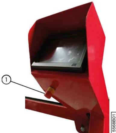
Fig. 44: Emplacement de l'arrêt d'urgence
