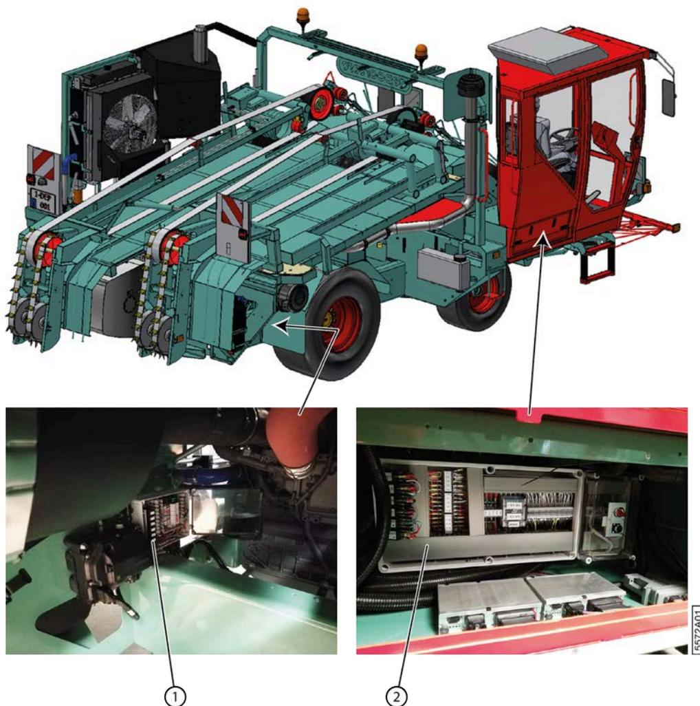
Fig. 27: Emplacement des armoires électriques
