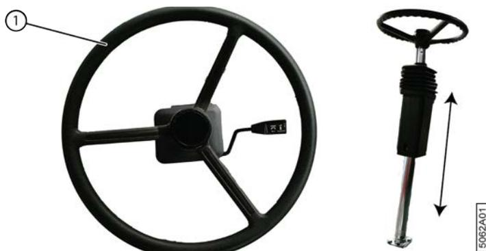
Fig. 81: Poignée de la colonne de direction
