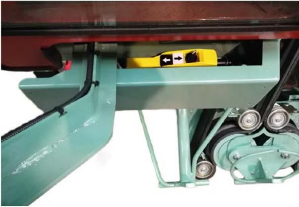
Fig. 25: Compartiment de rangement de la télécommande
