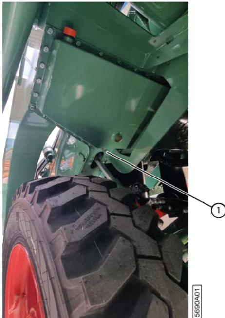
Fig. 109: Vider l'huile de l'engrenage de l'arracheur
