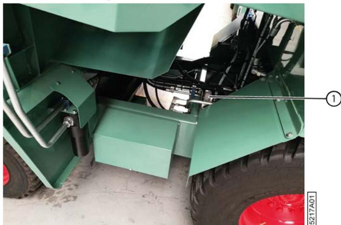
Fig. 184: Filtre du circuit de freinage
