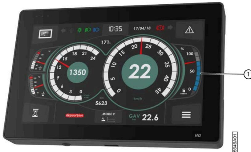
Fig. 127: Affichage du niveau AdBlue sur la fenêtre du mode route
