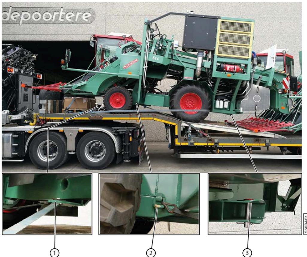
Fig. 47: Fixer la machine sur le camion
