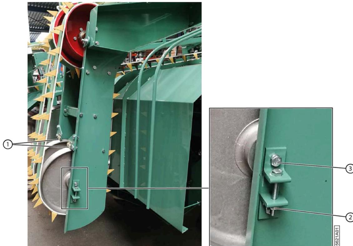
Fig. 94: Régler la tension des courroies de dépôt
