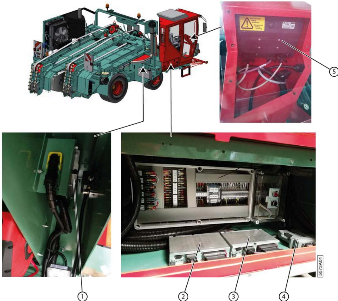
Fig. 28: Emplacement des contrôleurs
