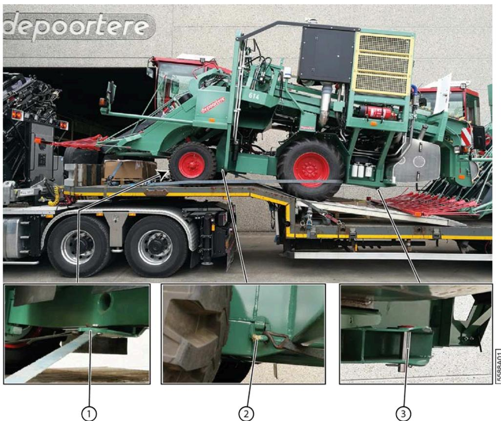
Fig. 46: Fixer la machine sur le camion
