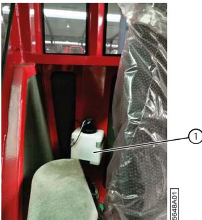
Fig. 129: Réservoir du liquide lave-glace
