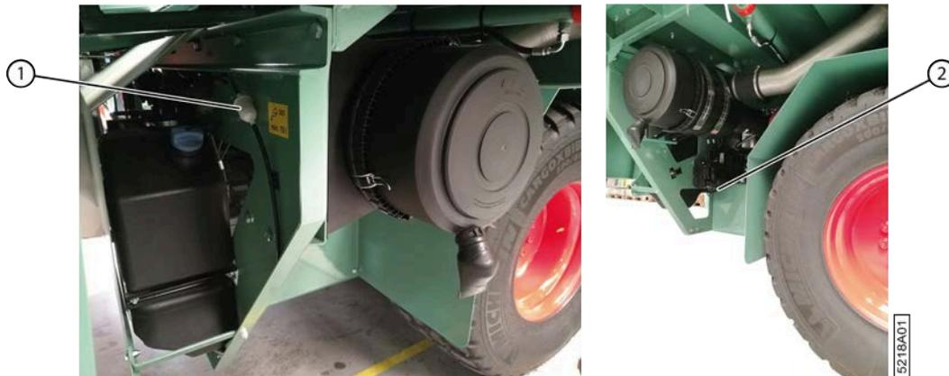
Fig. 183: Position des filtres AdBlue
