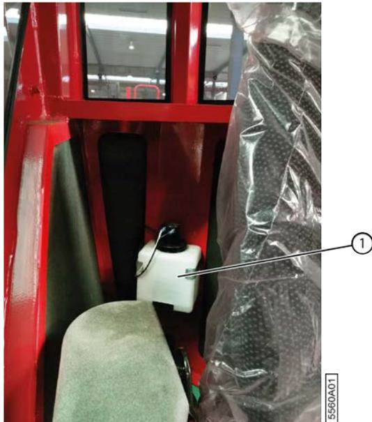
Fig. 14: Réservoir du liquide lave-glace
