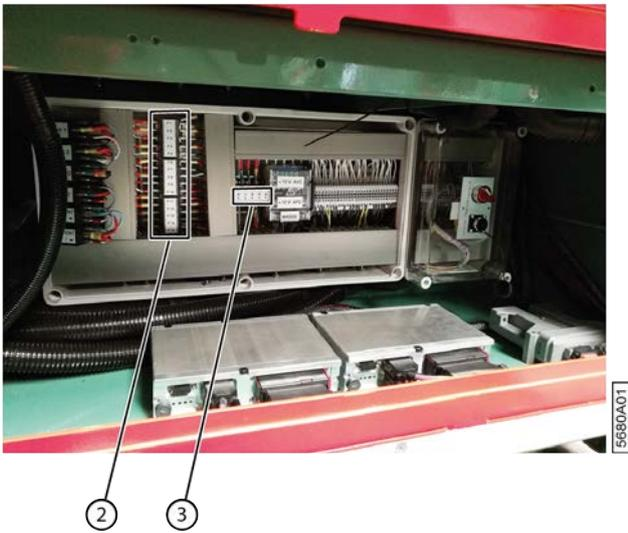
Fig. 175: Aperçu des fusibles dans l'armoire électrique
