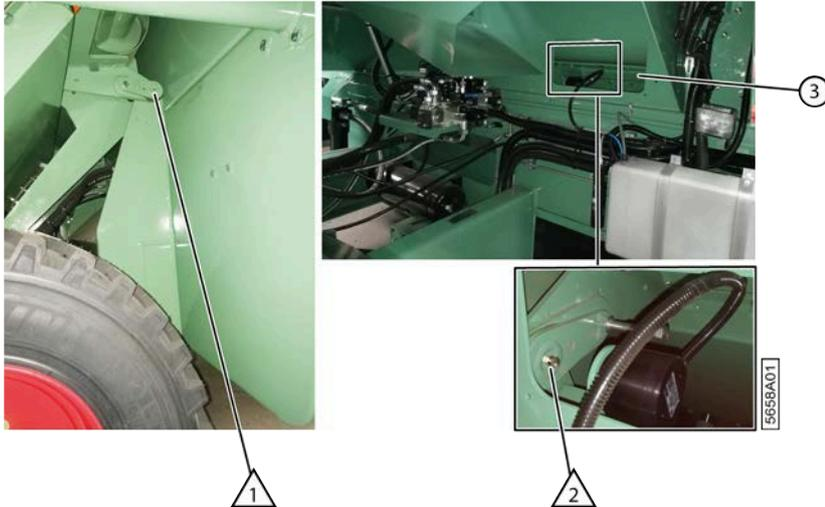
Fig. 140: Lubrifier les points charnières de l'arracheur
