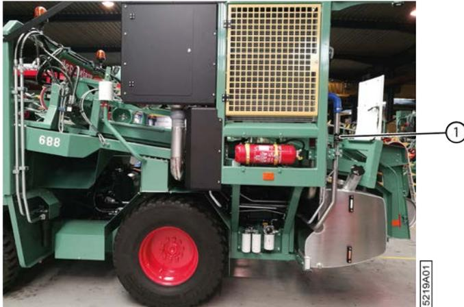
Fig. 182: Filtre d'aération du réservoir à carburant
